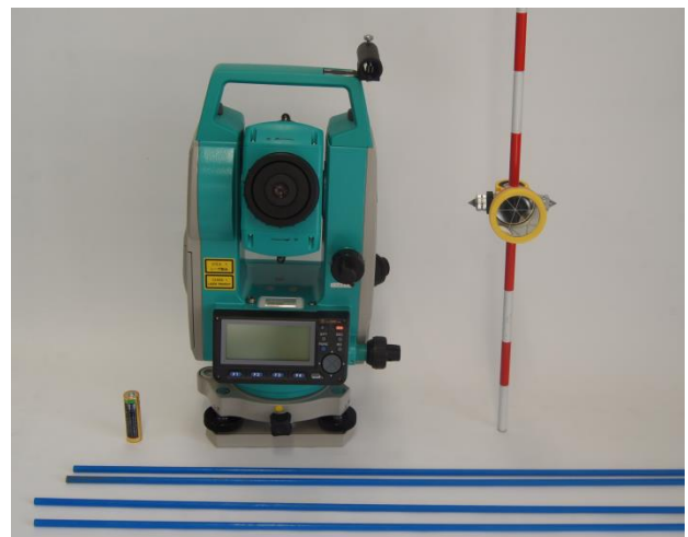
図2. 測量機器(左後ろ:比較用の単三電池、中央後ろ:トータルステーション本体、右後ろ:プリズム、手前:測点目印のピン(約長さ70cm))
