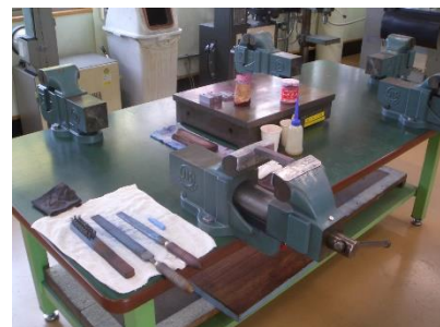
図7 手仕上げ作業
