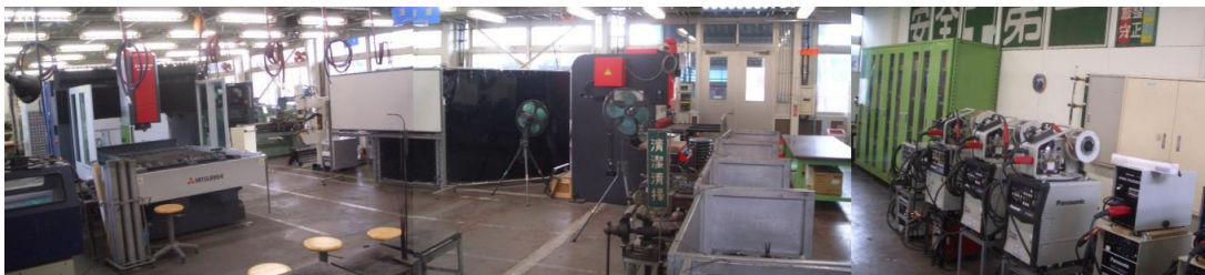
図14 板金工程 (左からレーザ加工機、溶接ロボット、プレスブレーキ、溶接機)
