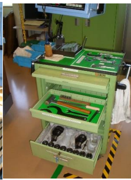
図5 フライス盤工具の使用状況、右は中央のキャビネットの拡大
