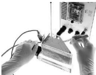
図1 実際のハルセル試験の様子
