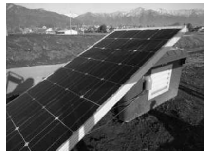
砂塵濃度測定システム
